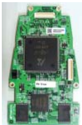
鉛フリーはんだ採用プリント基板
