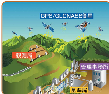
地すべり監視用GPS自動観測システム
