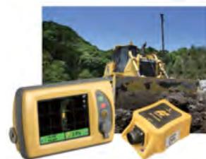
3D-MC<sup>2</sup>は、新開発のMC<sup>2</sup>センサーにより、3次元マシンコントロールにおける高速走行時の施工精度を大幅に改善しました。このMC<sup>2</sup>センサーは加速度計とジャイロセンサーを内蔵し、GPS測位データと結合させることで、高精度な制御が可能となり、ドーザーの排土板制御を設計図通りに細かく行うことができます。繰り返し施工のムダを減らし工期短縮することで、作業効率の向上、ひいては燃料代やCO<sub>2</sub>排出量の削減にもつながります。
