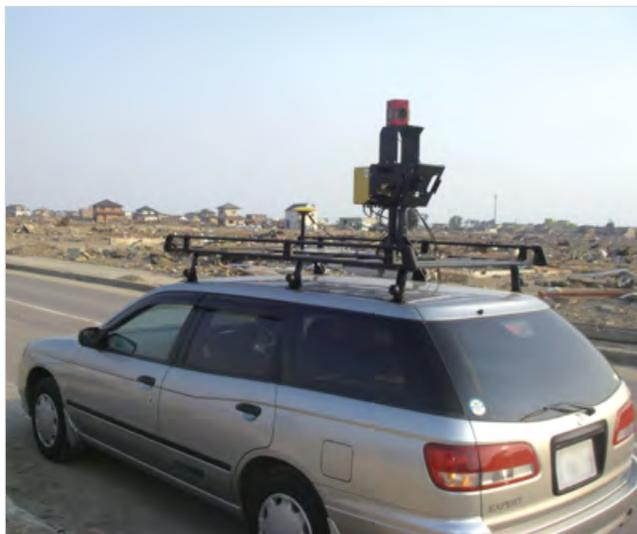
モバイルマッピングシステム「IP-S2 Lite」による計測
