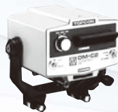
1979 光波距離計DM-C2
