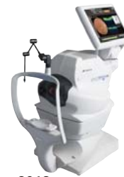
2013 3次元眼底像撮影装置 3D OCT-1 Maestro
