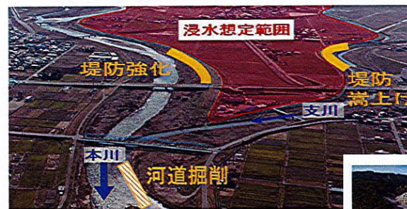
河川堤防強化等の緊急対策
