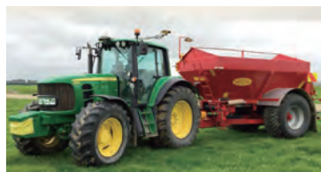
レーザー式生育センサーと自動操舵システムを搭載した肥料散布機
