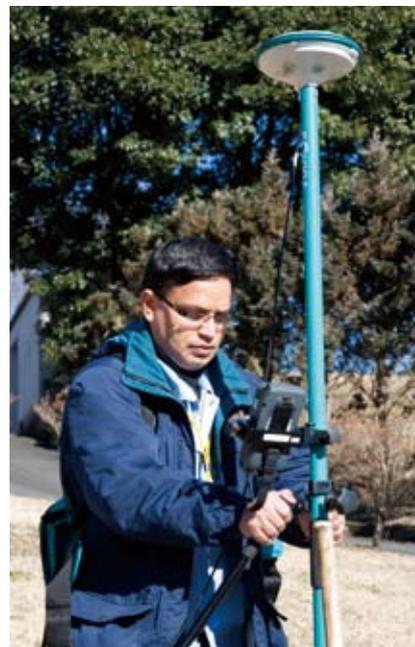
「GSR2600」を使い、ネットワーク型RTK-GPSの実習を行っている研修員。測点の中には、故意に建物などの影響で、GPS衛星からの電波が届きにくい点も設定し、そのようなケースの対処方法までも学ぶことができた。
