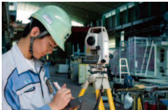
3Dステーション「NET1200」とコントロール・ターミナル「SDR4000」を用いて測定方法を再現してくれた大豊精機様の岩浅光太郎様。「ターゲットを1回測定するだけで、距離、水平角、鉛直角の数値を得られるので、とても簡単です」と語ってくれた。
