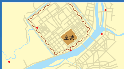
今回の調査で、建造物群周辺に5ヶ所の基準点情報を入手、踏査を行った。ベトナムの国家測地系VN2000にデータを移行するための基準点を確認できたことは大きな前進である。
