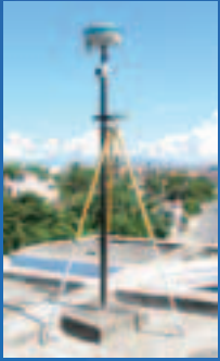
踏査した基準点を使って、GSR2700 ISXを試験活用した。
