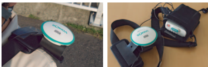
「GIR1600」は、本体からアンテナ部分を取り外すことができます。アンテナ部分を肩に載せてトレッキングスタイルにすることで、両手が自由に使える作業効率が大幅に向上。オプションの車載マウントセットを使えば、アンテナを車の屋根に設置でき、広範囲のデータ収集も効率的に行える。
