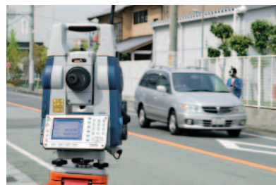
インタビュー当日、実際の作業をイメージして、観測していただいた。測点の前に車など障害物があっても観測にはなんら支障がなく、改めて「SRX」の性能の高さを確認することができた。
