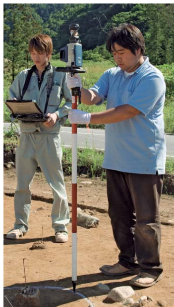
障害物の有無、高低、出土品の状況にあわせて、ソキア独自のピンポールとポールを選択。適材適所に選択できるソキアの“フリースタイル”が、計測効率アップを促進する。
