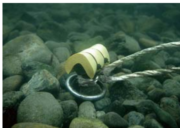
打ち込まれた直後の鉄杭(左)も、多くの土砂が流されるとその姿を露出してしまう(右)。
