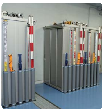
測量機器の収納庫。サイドにある標尺入れの筒は、(有)シニエイ測器・榎原部長のアイデアによる手づくりである。
