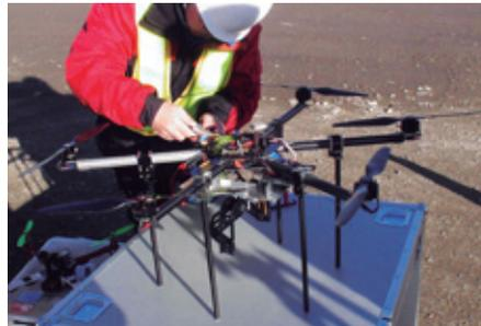
今回の検証に使用した UAV。このヘキサコプター (6 枚ローター) は、最大積載 2kg で約 15 分間の飛行が可能。
