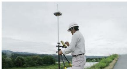
無線も一体型でケーブルが不要。とにかく軽いので移動が非常に楽です。それに初期化の早さには驚かされます。トータルステーションと異なり距離が伸びてもほぼ同じ精度で観測できる上に、総合精度でもTSと遜色ありません」と、使い勝手と性能の両面で高く評価する。前島様は、現況測量における前準備の時間短縮も利点として挙げる。「TSの場合は、プリズムとの間に草藪などの障害物があると視通を確保するための伐採に時間と労力を要します。それに測量範囲が広いとトラバースを行うための移動にも時間がかかります。しかしこのシステムでは視通がいらないので伐採の必要がほとんどなく、また測線をデータコレクタ上で見ることができるので測量作業が飛躍的にはかどります。延長1km以上の現場でも固定局はそのまま移動局に人員が充てられるので、スピーディに作業が進められました」
