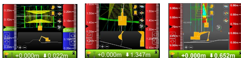
法面施工、平面、横断表示
