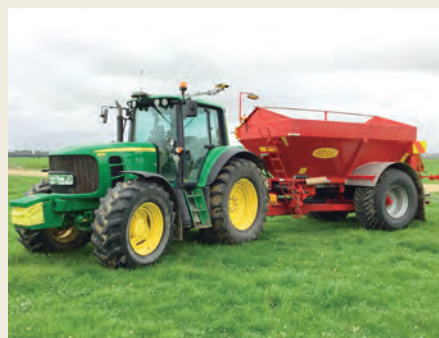
レーザー式生育センサーと自動操舵システムを搭載した肥料散布機
