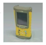
データコレクタ FC-100は、GPS、トータルステーション、電子レベルなどの測量機器のコントローラおよび観測データの保存に使用されるPDAタイプの製品です。様々なアプリケーションソフトへの対応と開発効率向上のため、Windows CEを搭載しました。ハードウエアは最新の高速、省エネCPUを採用し、ストレスを感じさせない操作性です。豊富な外部入出力ポート(CFカード、USB、Bluetooth)を用意し、現場作業での過酷な使用環境に耐えうる十分な防塵、防水、落下性能です。
